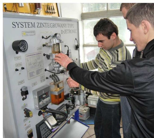
Uczniowie wykonują ćwiczenia symulacji usterek pracy układu wtrysku benzyny.
